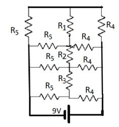
a)  $(9R_5/(R_5 + R_4)) * R_1/(R_1 + R_2 + R_3)$
